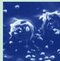
Die 500fache Vergrößerung eines Xeikon-Entwicklers zeigt die größeren Carrierpartikel und die kleineren Tonerpartikel.
